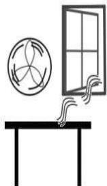
Non collocare vicino a finestre aperte o ventole per il condizionamento dell'aria che potrebbero causare letture instabili a causa delle correnti d'aria.
